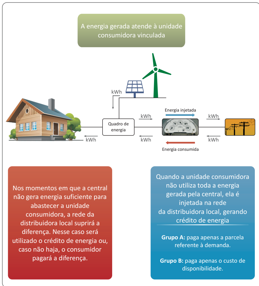
Figura 2 - Sistema de Compensação de Energia Elétrica
